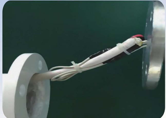
2, conecte tres cables de la turbina eólica al cable de transmisión, cada longitud del cable empalmado es de al menos 30mm; sujete los cables con cinta, su longitud es de aproximadamente 100mm. (hágalo como muestra la imagen de arriba)
